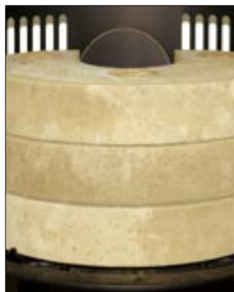
Accumulateur en thermo-béton.
